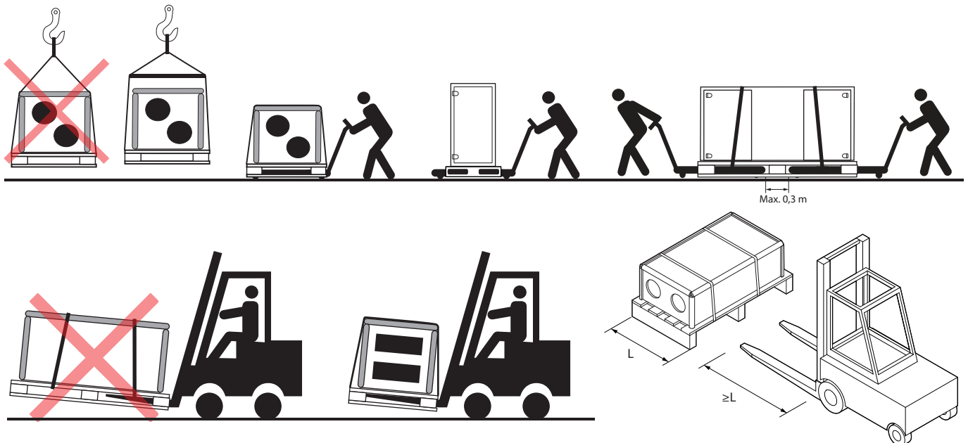
Afb. 5. Voorbeelden van verplaatsing per kraan, vorkheftruck en pompwagen
