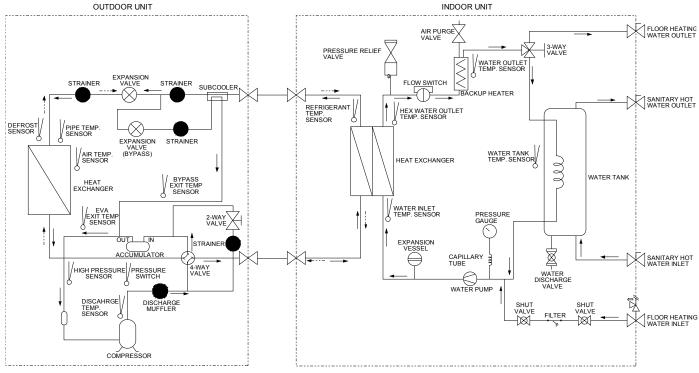
→ REFRIGERANT CYCLE (HEATING) ----→ REFRIGERANT CYCLE (COOLING)
