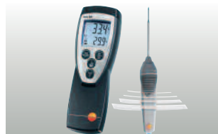
Draadloze meting met radiografische voelers
