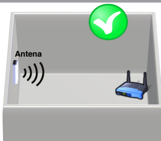
Antena w pozycji pionowej, skierowana na punkt dostępowy (AP) lub router Wi-Fi
