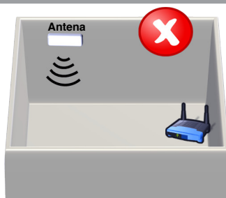
Antena w pozycji poziomej, nie skierowana na punkt dostępowy (AP) ani router Wi-Fi
