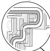
Retire el recubrimiento. Aprox. 9 mm
