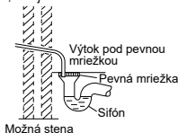
Znázornenie vedenia odtokovej hadice von
