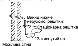
Ілюстрація направляючого дренажного шланга на вулицю
