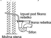
Risba napeljave odvodne cevi na prosto
