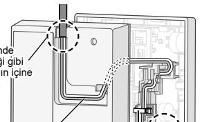
Kılıfı çizimde gösterildiği gibi arka kısmın içine doğru itin.
