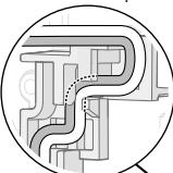
Снимите покрытие. Прибл. 9 мм
