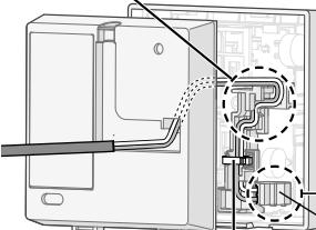
Płytkę zaciskową urządzenia zdalnego sterowania
