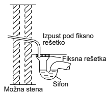
Risba napeljave odvodne cevi na prosto
