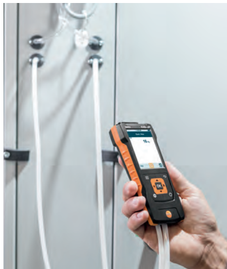
Met de testo 440 dP zijn metingen aan bijvoorbeeld klimaatinstallaties (verschuldruk over luchtfilter) snel uit te voeren.
