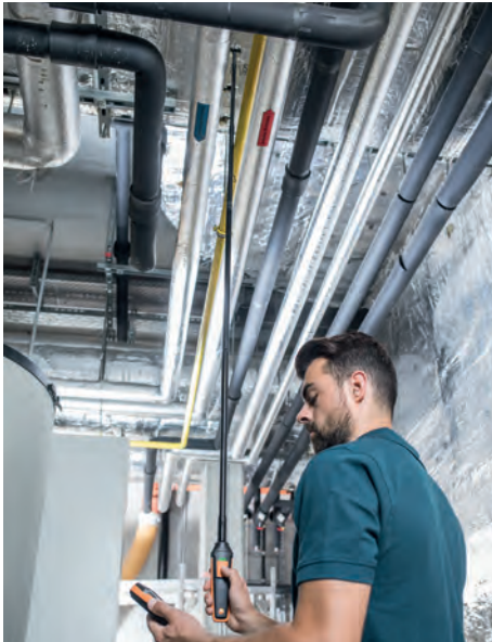
Alle testo 440 stromingssondes voor metingen in kanalen hebben een uittrekbare telescoop met schaalverdeling (optioneel te verlengen van 1 m tot 2 m).
